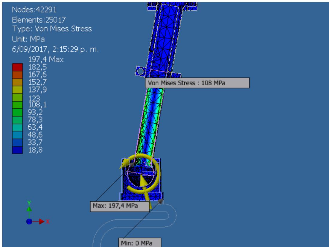
**Figura 32.** Esfuerzo Equivalente de von Mises máximo. Fuente Autor
